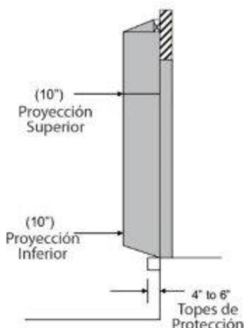
*Nota: Este sello de andén está diseñado para ser instalado en puertas hasta (e incluyendo) 9'-0" de ancho x 10'-0" de altura.*
